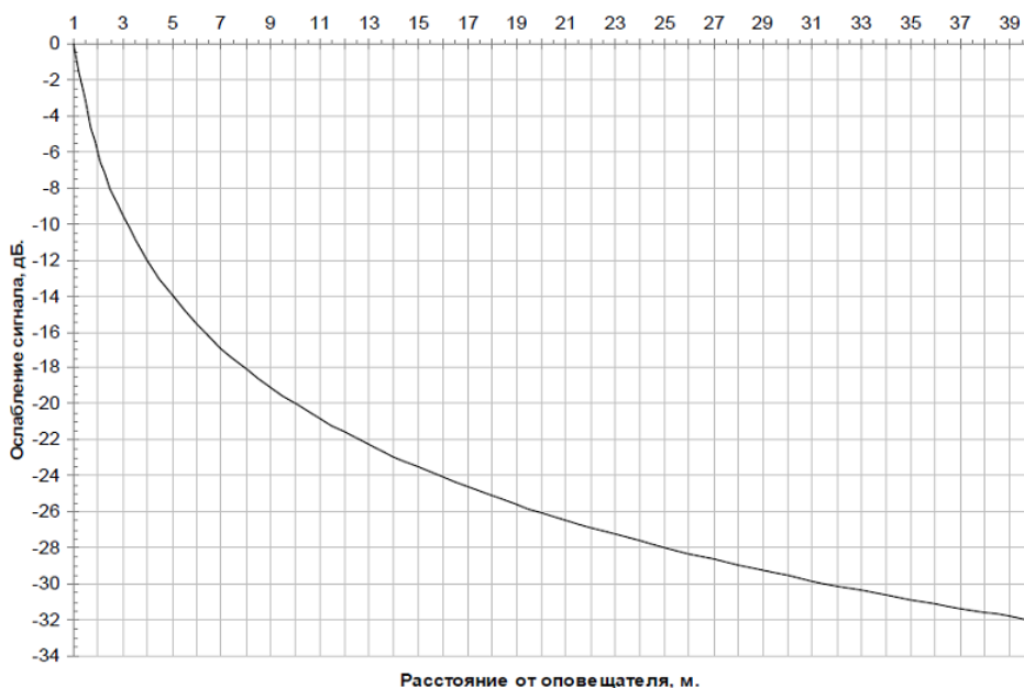
Рисунок 1 – график зависимости снижения уровня сигнала от расстояния до оповещателя
