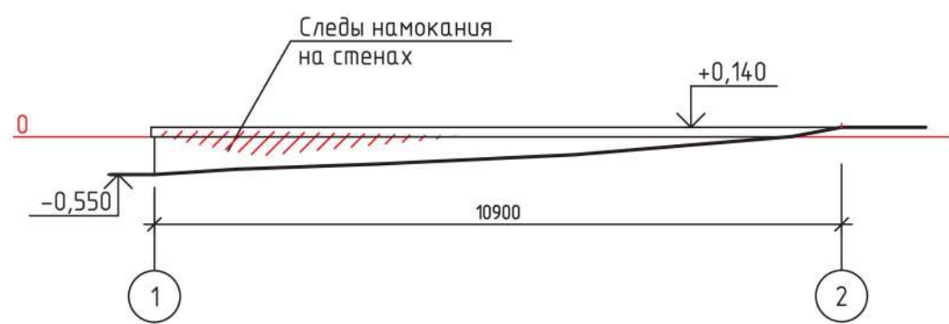
Обмерный чертеж наружной стены в осях 1-2
