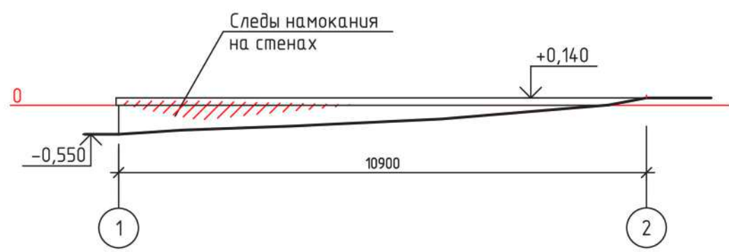
Обмерный чертеж наружной стены в осях 1-2
