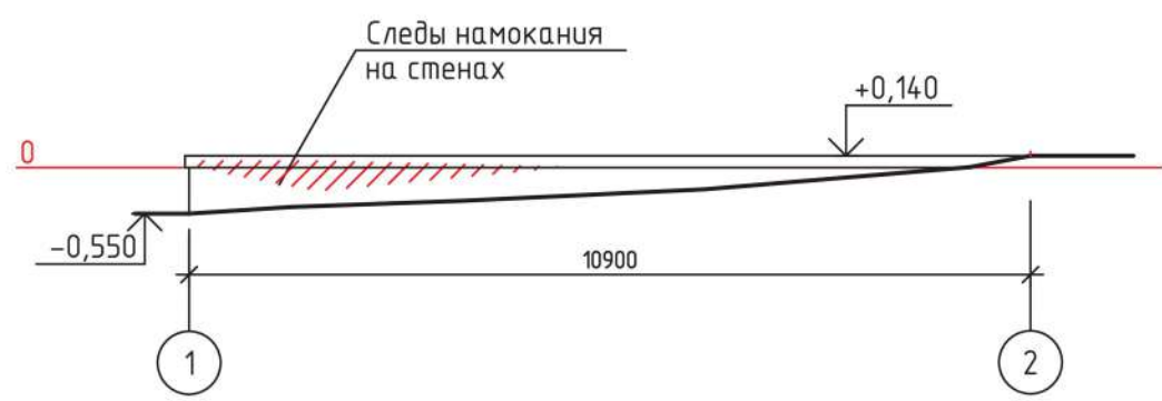
Обмерный чертеж наружной стены в осях 1-2
