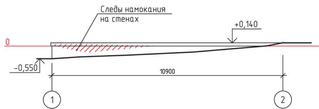
Обмерный чертеж наружной стены в осях 1-2
