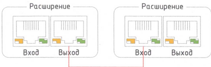
Схема подключения блоков в системе LPA-PRESTA-16
