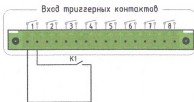
Схема подключения внешних сигналов управления к LPA-PRESTA-16
