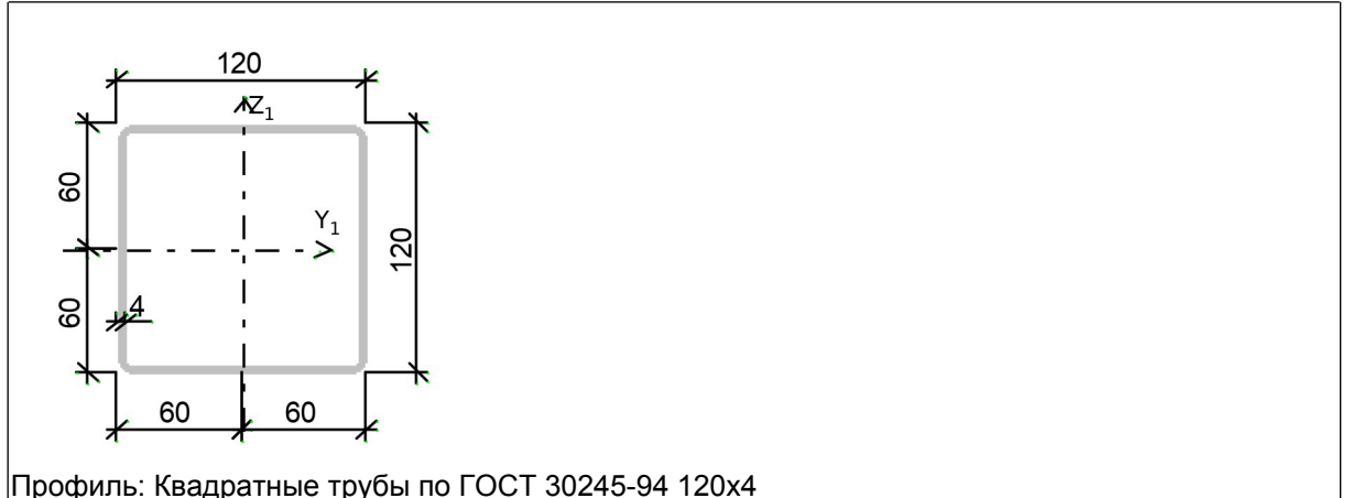
Профиль: Квадратные трубы по ГОСТ 30245-94 120x4
