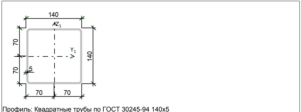
Профиль: Квадратные трубы по ГОСТ 30245-94 140x5
